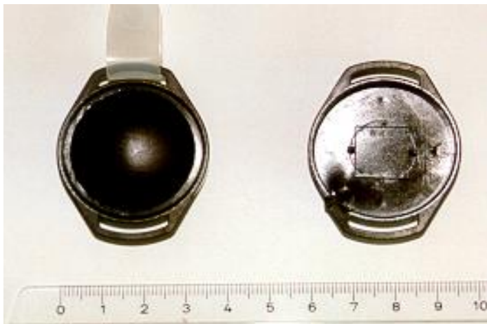
Abb. 1: Exposimeter; links komplettes System; rechts geöffnete Diffusionskammer mit innenliegendem CR-39-Detektor
