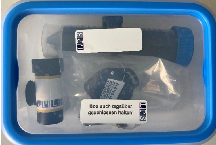
Abbildung: Radonbox mit dem Exposimeter (Nummer CP1529), einem Referenzexposimeter und der Aktivkohlepatrone
