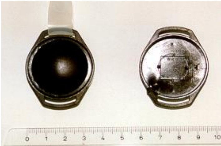
Abb. 1: Exposimeter; links komplettes System für die personendosimetrische Messung; rechts geöffnete Diffusionskammer mit innenliegendem CR-39-Detektor
