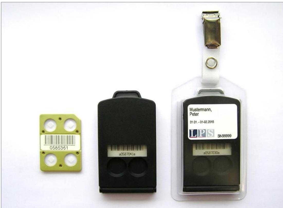
Über das Verhältnis beider Messwerte erfolgt eine grobe Energiebestimmung für die Neutronenstrahlung, was zusammen mit den vom Anwender gelieferten Informationen über das Strahlenfeld (Bereich N1 ... N4) die Dosisbestimmung innerhalb der von der PTB vorgeschriebenen Grenzen ermöglicht.
