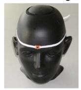
Teilkörperdosimetrie für die Erfassung der Strahlenexposition der Augenlinse in reinen Gamma-Strahlungsfeldern. Das Dosimeter wird mit einem Stirnband am Kopf getragen (andere Anwendungen nach Absprache möglich).
